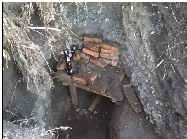
Fot. 1. Współczesny biedaszyb wykopany w 2015 roku w Katowicach-Piotrowicach
